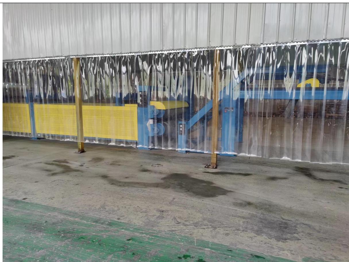
SMC 片材生产线废气收集措施
