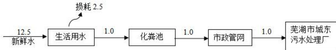
建设项目水平衡图 (t/d)
